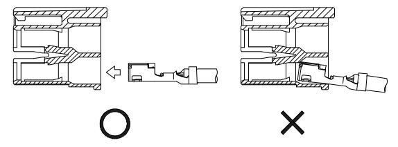
◇ ターミナルがハウジングから外れてこないかを確認するために、1本1本の電線を軽い カ(3. O N 程度)で引っ張ってしっかり挿入されていることを確認してください。 Pull the wire with light force (approx. 3.0N) to confirm whether the terminal would not come off. ◇ さらに、目視によりターミナルがハウジングのランスにしっかりとロックされていることを確認してください。
