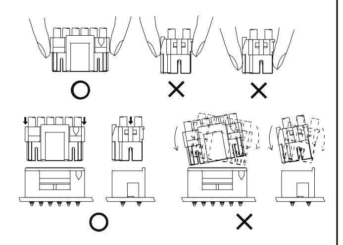
◇ ウエハーからの引き抜き時は、ハウジングロック解除部を押さえて(ロックが解除できる 程度の力)電線を保持しながらロックを完全に解除した状態で垂直方向に抜いて下さい。 ロックが完全に解除されていない状態で引き抜くとロック部やウエハーの破損原因となります。 また、電線(特に少数本)を引っ張って抜かないで下さい。(ターミナルが抜けてしまう場合があります。)
