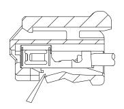
1) 先端が細い道具(精密ドライバー、治具等)をハウジングランスに差し込みランスを持ち上げターミナルを引き抜いて下さい。極端な持ち上げは、バネ性がなくなるため行わないで下さい。
