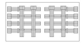
◇ 接触部の変形や異物の付着を防ぐために厚手の紙のような包装材料にてターミナルを保護 し適切な箱の中に収納してください。
