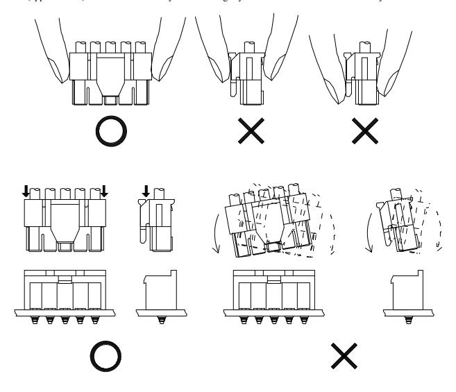
◇ ウエハーからの引き抜き時は、ハウジングロック解除部を押さえて(ロックが解除できる 程度の力)電線を保持しながらロックを完全に解除した状態で垂直方向に抜いて下さい。 ロックが完全に解除されていない状態で引き抜くとロック部やウエハーの破損原因となります。 また、電線(特に少数本)を引っ張って抜かないで下さい。(ターミナルが抜けてしまう場合があります。)
