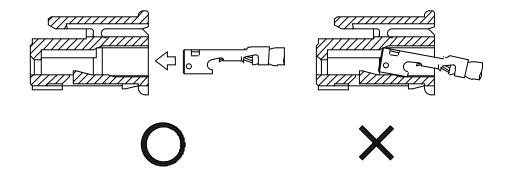
◇ ターミナルがハウジングから外れてこないかを確認するために、1本1本の電線を軽い カ(3.0 N程度)で引っ張ってしっかり挿入されていることを確認してください。 Pull the wire with light force (approx. 3.0N) to confirm whether the terminal would not come off. ◇ さらに、目視によりターミナルがハウジングのランスにしっかりとロックされていることを確認 してください。
