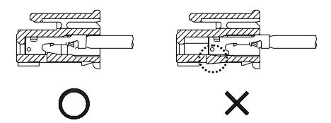
ターミナル誤挿入時の処理について Countermeasures for Incorrectly Inserted Terminal
