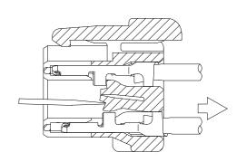
1) 先端が細い道具(精密ドライバー、治具等)をハウジングランスに差し込みランスを持ち上げターミナルを引き抜いて下さい。極端な持ち上げは、バネ性がなくなるため行わないで下さい。
