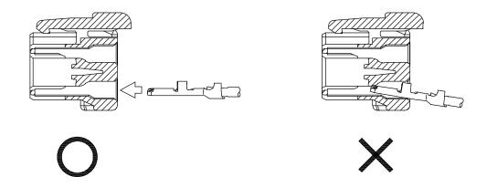
◇ ターミナルがハウジングから外れてこないかを確認するために、1本1本の電線を軽い カ(3.0 N程度)で引っ張ってしっかり挿入されていることを確認してください。 Pull the wire with light force (approx. 3.0N) to confirm whether the terminal would not come off. ◇ さらに、目視によりターミナルがハウジングのランスにしっかりとロックされていることを確認してください。
