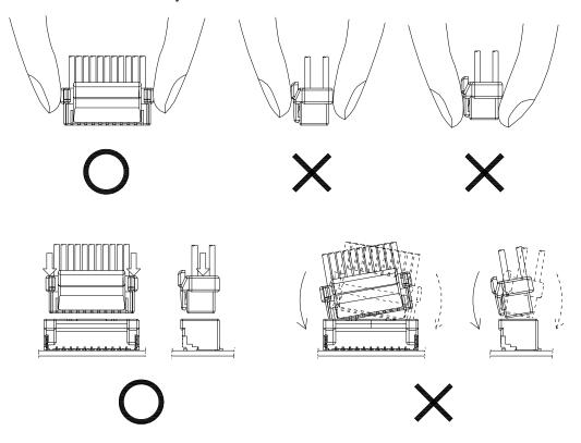
◇ ウエハーからの引き抜き時は、ハウジングロック解除部を押さえて(ロックが解除できる程度の力)電線を保持しながらロックを完全に解除した状態で垂直方向に抜いて下さい。ロックが完全に解除されていない状態で引き抜くとロック部やウエハーの破損原因となります。また、電線(特に少数本)を引っ張って抜かないで下さい。(ターミナルが抜けてしまう場合があります。)
