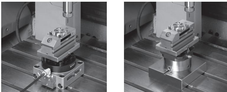
●Exc'sシステムとは、J.A.M.精密バイスにオリジナルサブプレートを取り付けしたもので、マクロパレット (System-3R社) または、センタリングプレート (EROWA社) を組み合わせる事によりご使用になれます。
