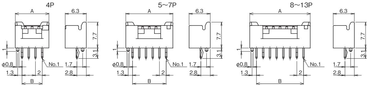
DIP、ライトアングル型ボス付き、フォーミングタイプ (DIP, Right angle Type with Boss, Forming Type)
