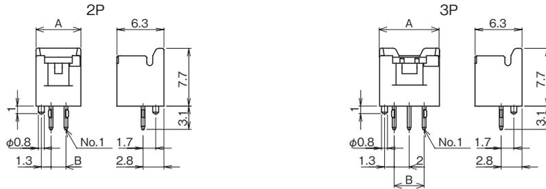
DIP、ストレート型ボス付き、フォーミングタイプ (DIP, Straight Type with Boss, Forming Type)
