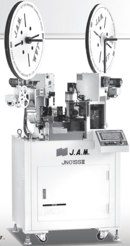
**全自動端子圧着機（両端圧着挿入） FULLY AUTOMATIC CRIMPING MACHINE (DUAL-END CRIMP AND INSERTION)**
