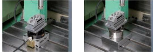
Exc'sシステムとは、J.A.M.精密バイスにオリジナルサブプレートを取り付け
