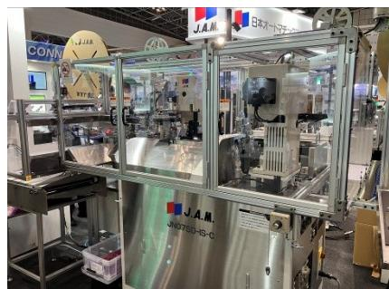
【両端圧着・片端挿入機『JN07SD-IS-C』は稼働データ監視システムと連動した実演を行いました】
